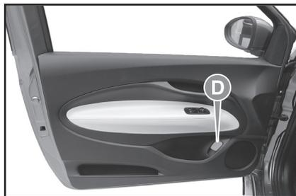
リモコンキーやウェアラブルキー<装備車>または車両の12Vバッテリーの電圧が低下したときなど、リモコンキーやウェアラブルキーが作動しないときは、フロントドアにある緊急レバー
